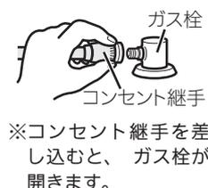
ガス栓を閉めるときはコンセント継手のスリーブ (白色) を手前に引きます。
