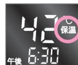
保温の表示が出ている間は、お湯の温度が下がると自動的(注)においだし、全自動タイプはお湯が減ると自動的にたし湯します。この保温時間は44ページのふろ保温時間の変更方法で決めます。
