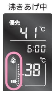
音声で『湯はりします』とお知らせして自動スイッチが赤く光り、浴槽に湯はりを始めます。このとき表示画面には右図の表示が出ます。また、湯はり完了の約5分前には『残りおよそ5分でおふろが沸きます』とお知らせします。
