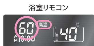
給湯栓を開くとお湯が出ます。お湯を使っている間は、表示画面に右図のような燃焼表示をします。湯量を絞りすぎる(毎分約2リットル以下にする)とバーナの火が消えます。
