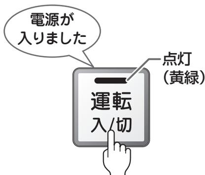
表示画面に給湯温度などが表示されます。
