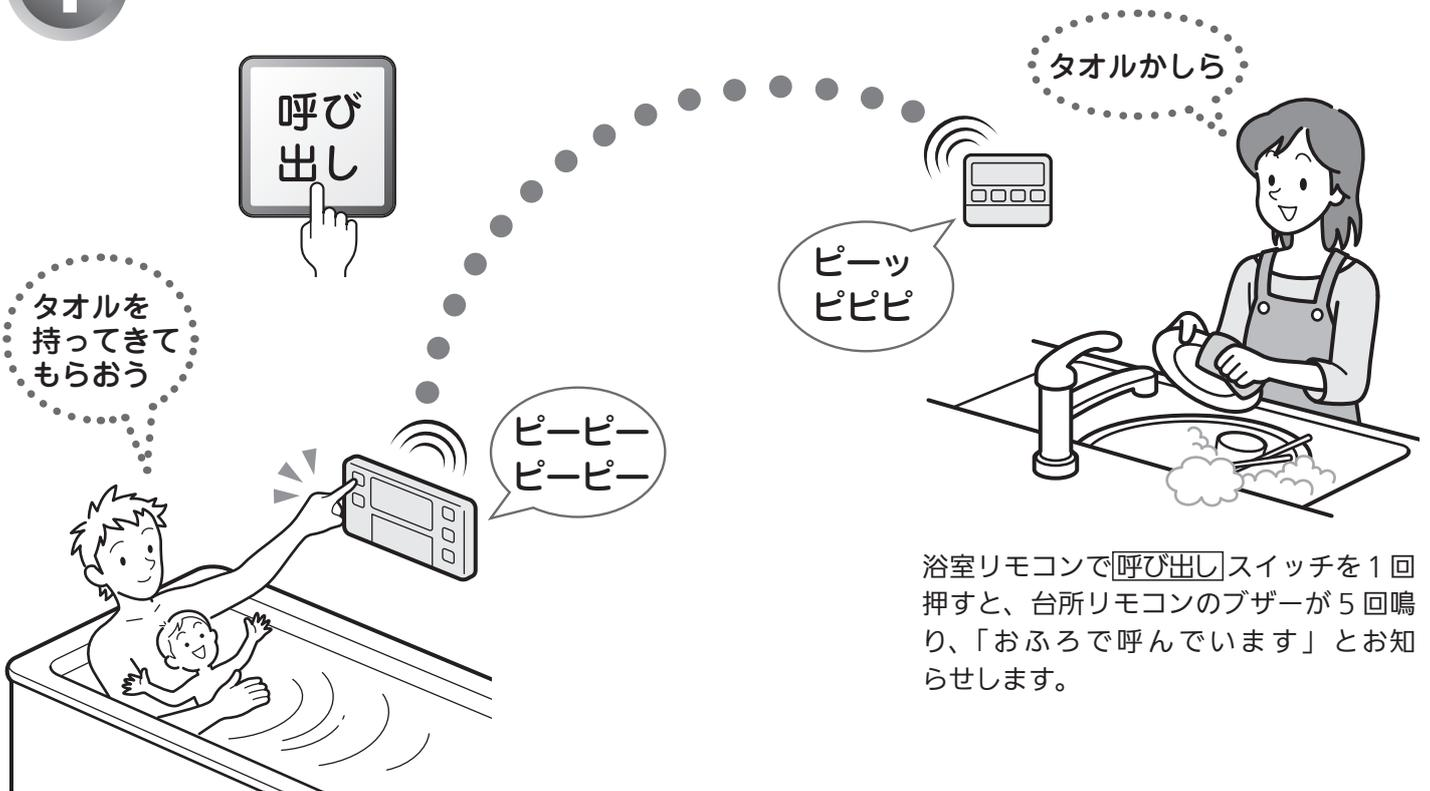
呼び出しスイッチを押している間、台所リモコンで呼び出し音が鳴り続けます。
