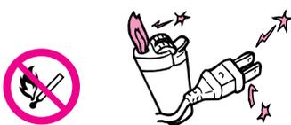
電気器具(換気扇など)のスイッチの「入・切」禁止
