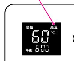
本体操作部の表示例。増設リモコンおよび浴室リモコンにも点灯します。
