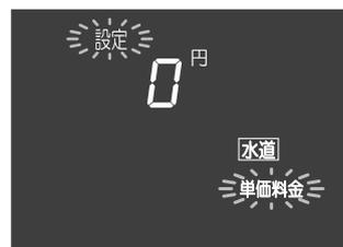
⑦ ふろ温度・時間設定スイッチで水道単価料金を設定する。
