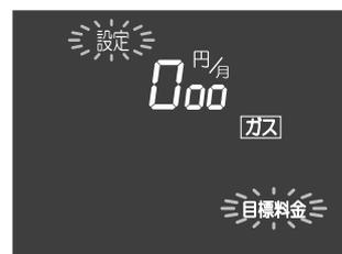
⑤ ふろ温度・時間設定スイッチで目標ガス料金を設定する。
