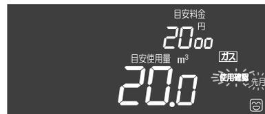
⑤ 再度 **表示切替** スイッチを押すと、前年同月の使用量実績を表示できます。
