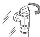
〔ガス元栓の例〕
