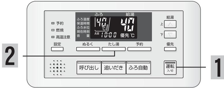
**手動配管クリーンをする** ふろ配管内の残り湯をきれいなお湯で流し出す機能です。浴室リモコンで操作します。
