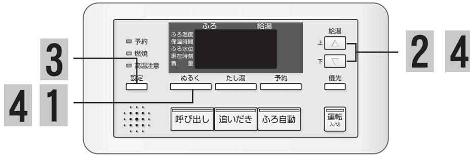
**ふる待機設定をする** ふる自動運転のお湯張り中やたし湯運転中に給湯・シャワーを使用した場合、給湯温度で出湯することができます。お湯を使用している間はふる自動運転のお湯張りやたし湯を停止(待機)することになります。浴室リモコンで操作します。
