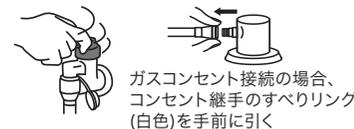
ガスコンセント接続の場合、コンセント継手のすべりリング(白色)を手前に引く
